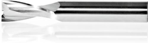
Speziell für Aluprofile im Fenster- und Türenbau auf CNC Mehrwegemaschinen. Baumaße nach DIN 6527 L. Gute Bohr- und Taucheigenschaften. Zur gratarmen Bearbeitung, auch von Alu/Kunststoffkombinationen.
