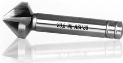
Speziell für den Einsatz auf Bearbeitungszentren. Die Einsatzwerte gelten für Senkungen nach DIN (Senkkopfschrauben). Entgraten oder Gewindeschutzsenkungen sind auch in Stahl und VA gut möglich, bitte auf **ausreichende** Schmierung achten.
